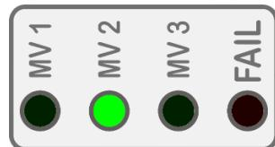
Nach dem Einschalten des Geräts leuchten zunächst alle LEDs stetig, so lange das Boot-Menü in der LCD-Anzeige dargestellt wird (ca. 4 s). Danach ist das Gerät einsatzbereit.
