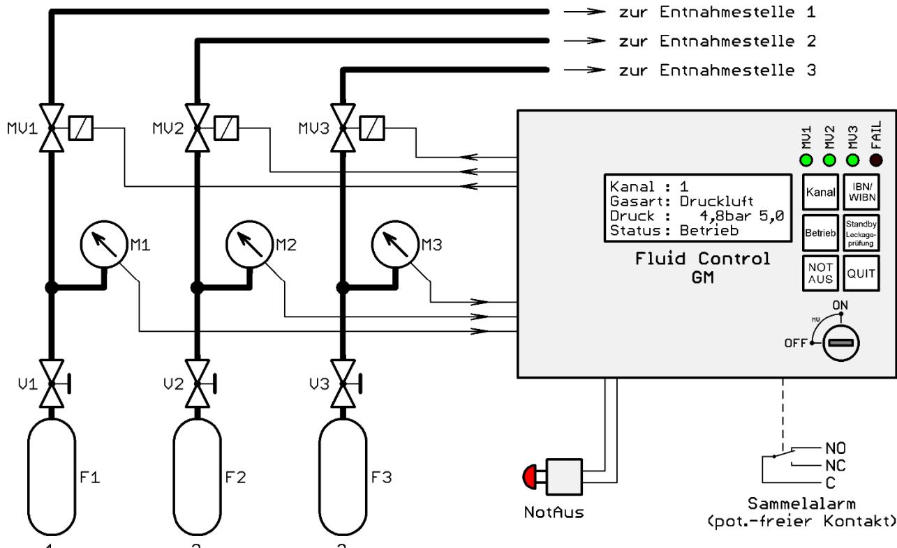
**Funktionsprinzip:** Die Darstellung gilt für die maximale Ausbaustufe. In der gezeigten Situation ist der Kanal "1" zur Anzeige ausgewählt und es liegt keine Fehlermeldung vor. Anhand der LEDs ist zu erkennen, dass auch die Kanäle "2" und "3" in Betrieb sind.
